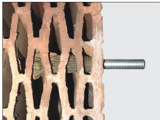
Фото 1. Применение химических анкеров в основах с пустотами
